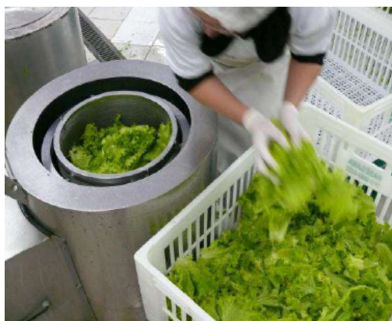
Figura 7. Abastecimento manual da centrífuga com alfaces para etapa de centrifugação
