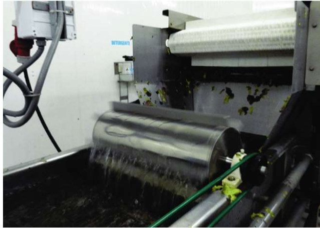
Figura 5. Lavagem com sistema de tambor rotativo
