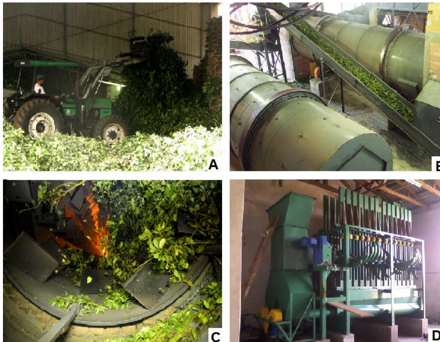
Figura 2. Etapas de cancheamento da erva-mate. A: Recebimento. B: Secagem. C: Sapecamento. D: Moagem. FONTE: Ervateira Taquapy (A); Maqui Ervas (B); Ervateira Sabatin (C); IB Equipamentos (D)
