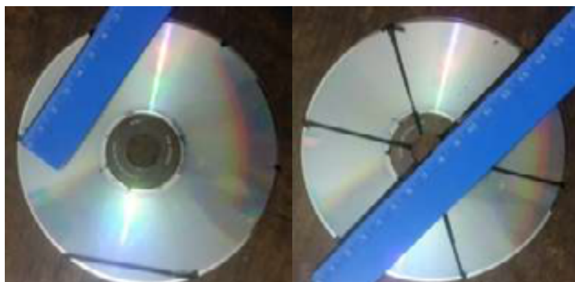
Figura 3.5: Base do estator.
